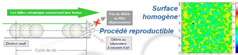
Figure 8.2 Propriétés du grenailage céramique
