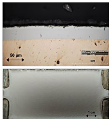
Images microscopie optique numérique d'une coupe d'un dépôt de chrome à partir d'une électrolyte Dura-Tri 240 (à gauche) et vue de dessus d'une éprouvette en acier 15CDV6 revêtue (à droite) – source UTINAM UFC CNRS projet IRT M2P CRONOS 2024
